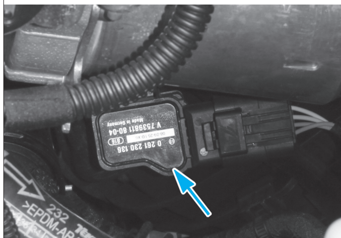
CAPTEUR DE PRESSION ET SONDE DE TEMPÉRATURE D'AIR D'ADMISSION
